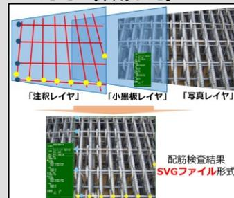
工事写真レイヤ化に適合
